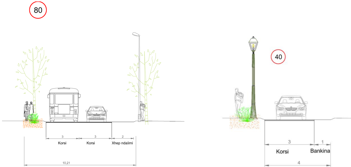
Figura 21 Profil rrugë interurbane dytësore (majtas) dhe rrugë lokale (djathtas)
